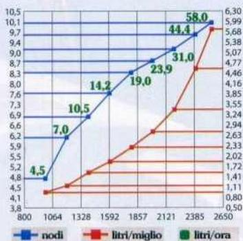
*I consumi indicati nel grafico sono stati rilevati sul computer di bordo, ma il consumo reale in mare potrà discostarsi dai dati pubblicati in funzione del carico imbarcato e della sua posizione, delle condizioni di uso dell'unità, della messa a punto e dello stato dei motori stessi, oltre che dalle caratteristiche delle eliche utilizzate.*
